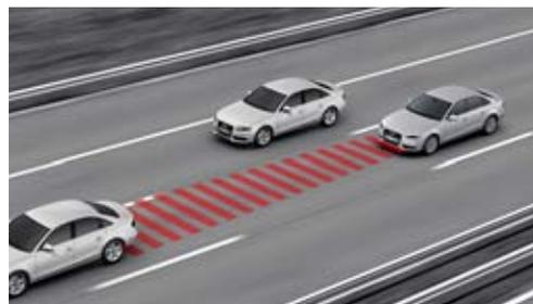
**cruise control adaptativo\***: identifica os veículos que circulam à frente através de um sensor de radar, regulando automaticamente a velocidade e a distância programadas pelo condutor, através de travagens e acelerações precisas, dentro dos limites do sistema.
