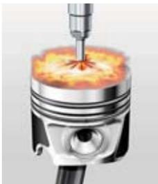
**Os injetores piezo** no motor 3.0 TDI abrem e fecham em milésimos de segundo e injetam o combustível várias vezes por ciclo de injeção na câmara de combustão com uma pressão até 2.000 bar. Em cada ciclo de injeção, são injetadas quantidades mínimas de combustível, inferiores a um milésimo de grama.
