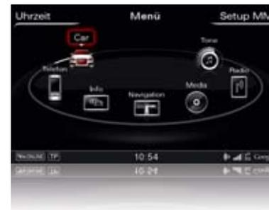
**Car:** esta função permite operar diretamente os sistemas de assistência ao condutor, as configurações do veículo, o ar condicionado, o aquecimento e ventilação de parque e o serviço.
