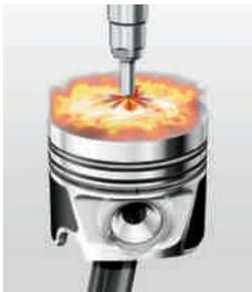
Os **injetores piezo** abrem e fecham em milésimos de segundo e injetam o combustível várias vezes por ciclo de injeção na câmara de combustão com uma pressão até 2.000 bar. Em cada ciclo de injeção, são injetadas quantidades mínimas de combustível, inferiores a um milésimo de grama.
