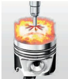
A **pré-injeção** conduz a uma sequência de combustão “suave” e, por conseguinte, a uma excelente acústica e agradável sonoridade do motor.
