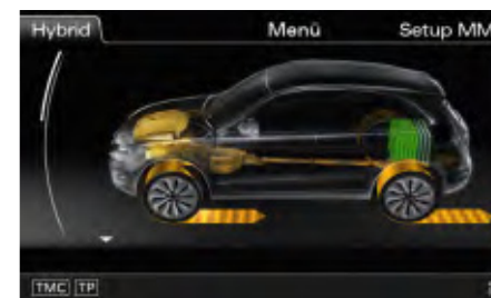
Modo híbrido com funcionamento paralelo do motor de combustão com o motor elétrico
