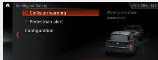
□ O equipamento de segurança do assistente de condução<sup>4</sup> chama a atenção do condutor para alterações não intencionais de faixa de rodagem ou para possíveis colisões, travando automaticamente em caso de emergência.
