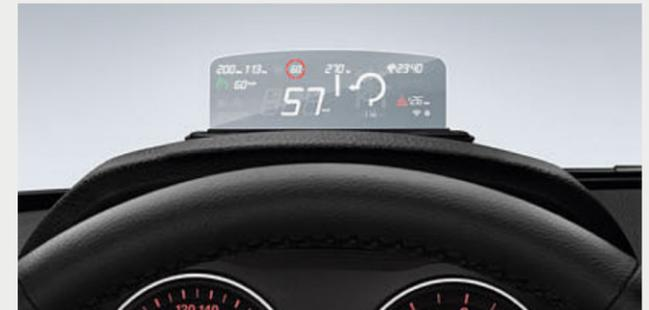
○ O BMW Head-Up Display projeta a informação do veículo e do sistema de navegação no campo de visão do condutor – em combinação com uma interface de Smartphone.
