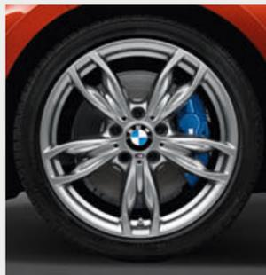
□ Jantes de liga leve BMW 436 M de raios duplos de 18" com pneus mistos, 7,5 J x 18 com pneus 225/40 R 18 à frente, 8 J x 18 com pneus 245/35 R 18 atrás.<sup>2</sup>
