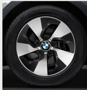
□ Jantes de liga leve BMW EfficientDynamics 406 de raios em forma de pás de turbina de 16", aerodinamicamente otimizadas, cinza Orbit, polidas, 7 J x 16 com pneus 205/55 R 16.
