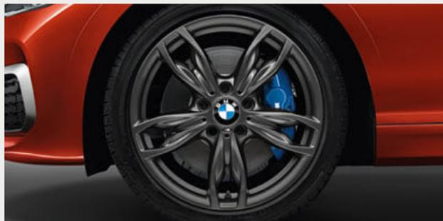
□ Jantes de liga leve BMW 436 M de raios duplos de 18", cinza Orbit metalizada, com pneus mistos, 7,5 J x 18 com pneus 225/40 R 18 à frente, 8 J x 18 com pneus 245/35 R 18 atrás.<sup>3</sup>
