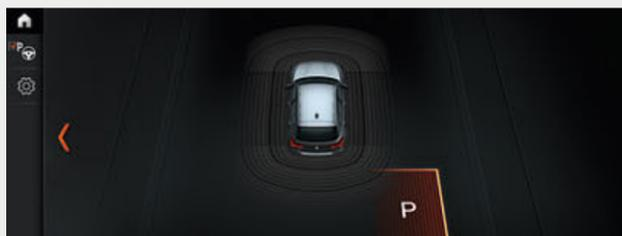
□ O assistente de estacionamento facilita o estacionamento em paralelo e perpendicular à via. O sistema assume a direção enquanto o condutor mantém o controlo do acelerador, do travão e das mudanças de velocidade.
