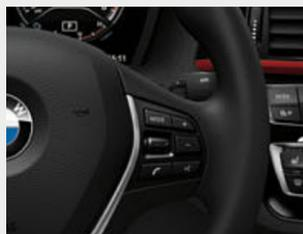
□ Os botões multifunções para o volante podem ser utilizados como controlos do telemóvel, do controlo de voz e das funções de áudio, e também do limitador de velocidade manual.
