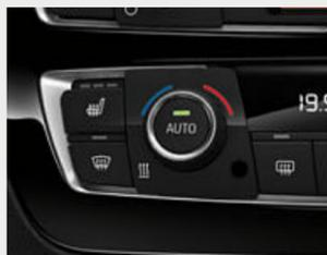
□ O ar condicionado automático com controlo de duas zonas inclui a recirculação automática do ar (AAR) com um filtro de carvão ativo, bem como sensores de embaciamento e sensores de luz solar.
