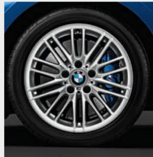
□ Jantes de liga leve BMW 460 M de raios duplos de 17" com pneus mistos, 7,5 J x 17 com pneus 225/45 R 17 à frente, 8 J x 17 com pneus 245/40 R 17 atrás.<sup>1</sup>
