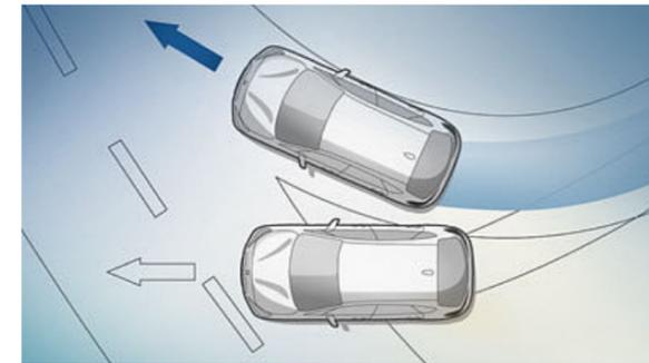
■ O **controlo dinâmico de estabilidade (DSC)** monitoriza permanentemente os movimentos do veículo, otimizando a estabilidade direcional e a tração.
