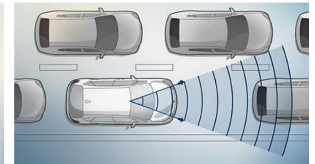
□ O **sistema de assistência em trânsito<sup>2</sup>** controla a velocidade do automóvel, bem como a distância em relação ao veículo da frente, em situações de trânsito intenso em autoestrada e a velocidades até 60 km/h, controlando inclusivamente a direção.
