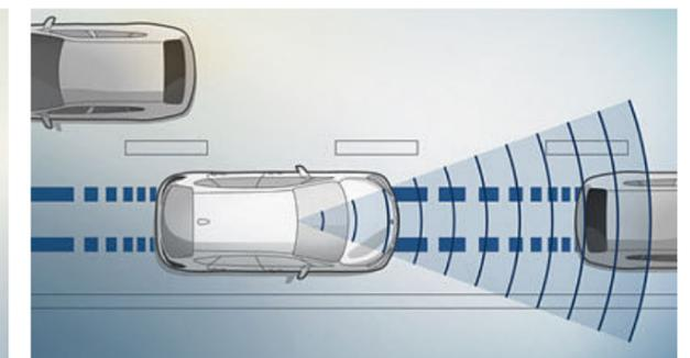
■ O **aviso de colisão com ativação automática dos travões<sup>3</sup>** representa uma assistência ativa ao condutor para evitar ou minimizar a gravidade das colisões traseiras. Esta função é ativada a velocidades até 60 km/h e configura previamente os travões para uma maior sensibilidade. O sistema aplica automaticamente os travões em caso de emergência.
