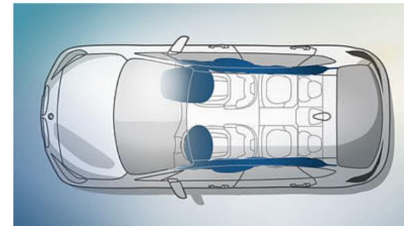
■ **Airbags para o condutor e passageiro da frente.** Os airbags para a cabeça e os airbags laterais integrados nas costas dos bancos dianteiros proporcionam aos ocupantes uma proteção estratégica.
