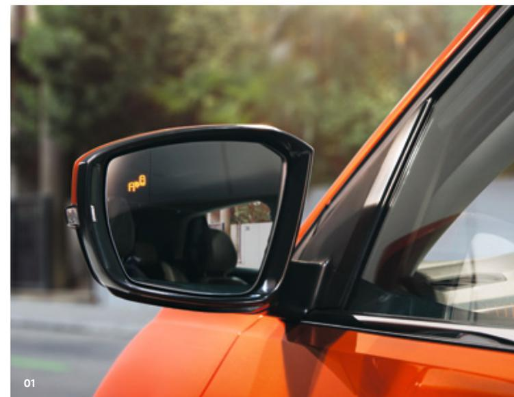
**01** Durante a condução, o sensor "Blind Spot" pode avisá-lo da existência de automóveis na zona do ângulo morto, por meio de LED no respetivo espelho retrovisor exterior.<sup>1)</sup> Ao sair de um lugar de estacionamento em marcha-atrás, o assistente integrado de saída do lugar de estacionamento pode monitorizar a zona por detrás do automóvel, avisando-o do trânsito em circulação.<sup>1)</sup> **O**
