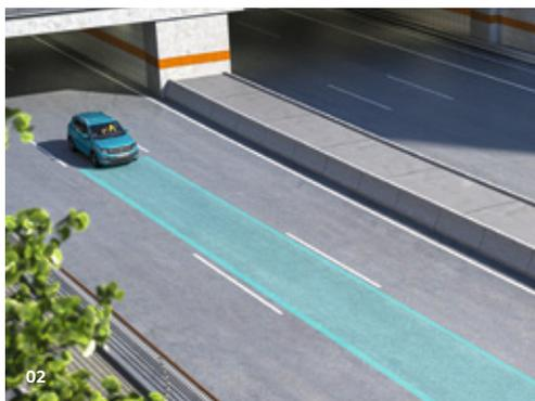
**02** O assistente de manutenção na faixa de rodagem "Lane Assist" consegue detetar, a partir de uma velocidade de 60km/h, se o veículo saiu inadvertidamente da sua faixa de rodagem.<sup>1)</sup> Através de uma intervenção corretiva na direção, o sistema pode chamar a atenção do condutor para a situação de condução.<sup>1),2)</sup> **S**
