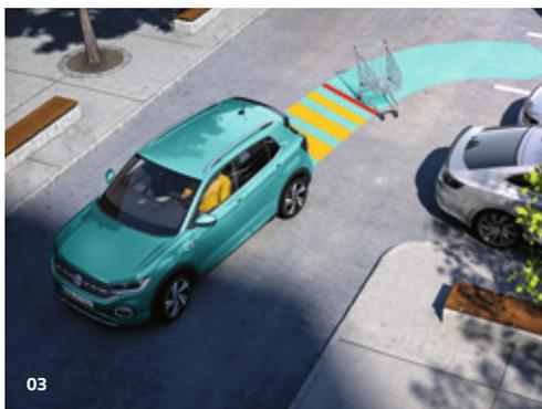
**03** Ao manobrar para estacionar, o sistema auxiliar de estacionamento avisa-o, através de sinais sonoros e visuais, da existência de obstáculos à frente e atrás do veículo.<sup>1)</sup> A função de travagem de estacionamento incluída pode evitar uma colisão ou minimizar os danos, através de uma travagem de emergência ao fazer marcha atrás até 10km/h.<sup>1)</sup> Ao circular para a frente, também pode ativar a função de travagem de estacionamento, com o simples toque de um botão. **O ST**
