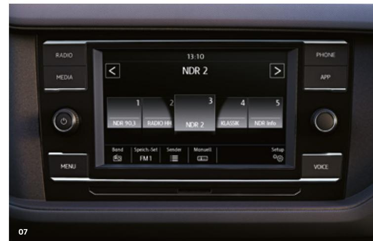
**07** O rádio "Composition Colour" com um monitor a cores TFT 16,5cm (6,5") e ecrã tátil, DAB+, potência de 4 x 20 Watts e seis altifalantes também está equipado com dois interfaces USB (modelo C). Pode, ainda, conectar o seu telemóvel via Bluetooth. **S**
