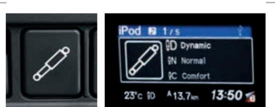
• O botão do Sistema de Suspensão Adaptável está convenientemente colocado à frente do punho das mudanças.
