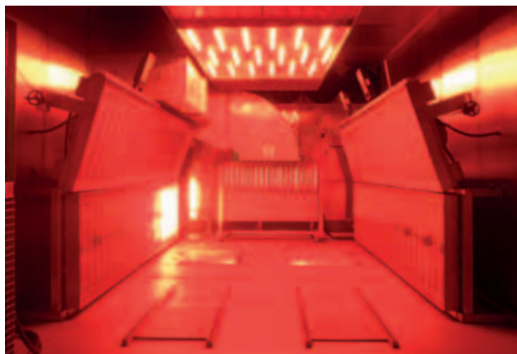
Câmara climática Honda na fábrica de Swindon.
