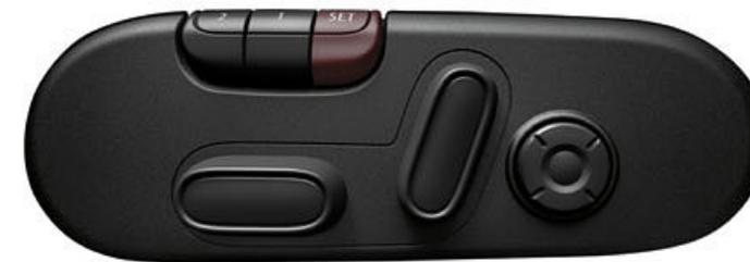
O opcional bancos dianteiros elétricos, permite o ajuste longitudinal, da altura e inclinação da base, assim como do ângulo das costas. Inclui função memória para o banco do condutor e diversos ajustes para o apoio lombar.
