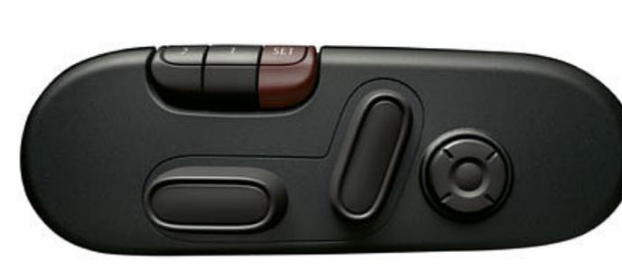
O ajuste elétrico dos bancos dianteiros, bem como do apoio lombar inclui função de memória para as definições favoritas.
