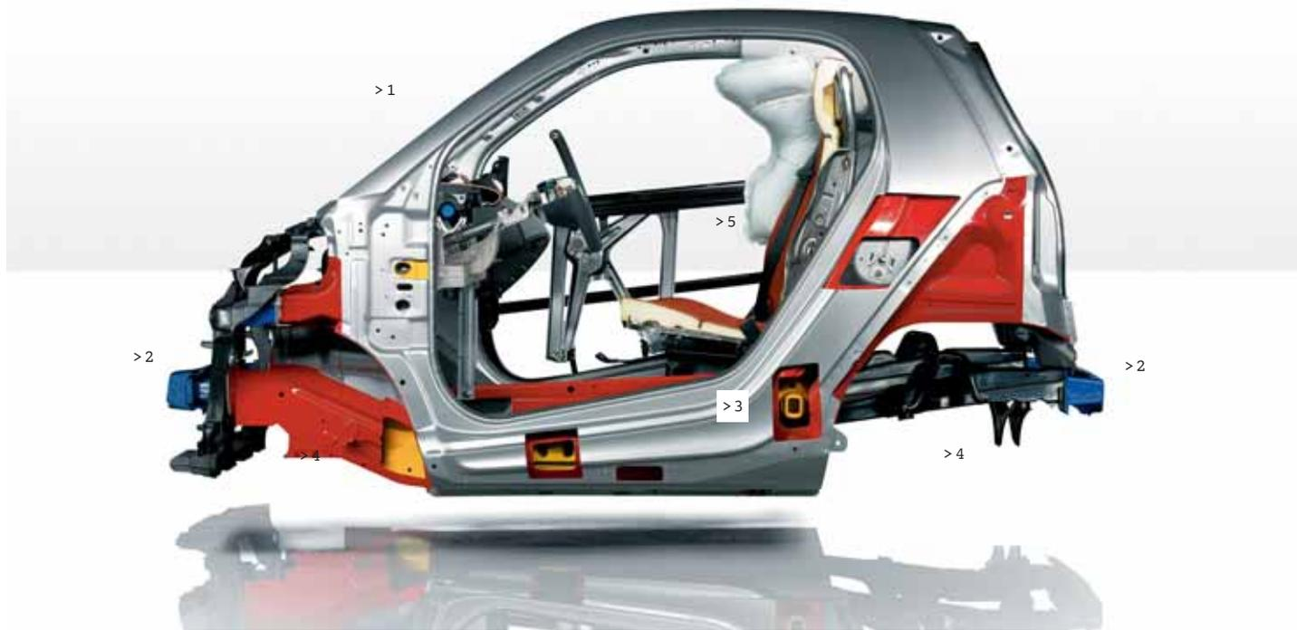
> 1 **A célula de segurança tridion:** sólida, rígida e resistente. A célula de segurança em aço possui reforço adicional com componentes de aço extremamente fortes em pontos estratégicos e importantes. Além disso, as barras longitudinais e transversais distribuem uniformemente a energia da colisão.
